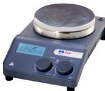
Réglage de la température et réglage de la température de sécurité. Sonde de température Pt1000 pour une régulation précise à partir de la température d'échantillon.
